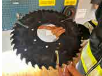
Sågklingan kan också optimeras. Kan den bli tunnare med coating och tänderna kanske tunnare så blir det en mindre mängd spån. På en årsproduktion kan en sådan förbättring ge stora volymer extra virke i utbyte.
