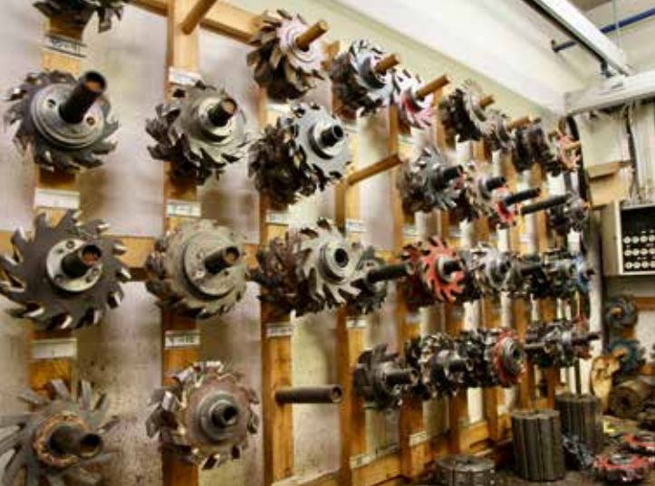
Verktygen kan anpassas i hyveln så att varje panel får exakt rätt utsnitt.
