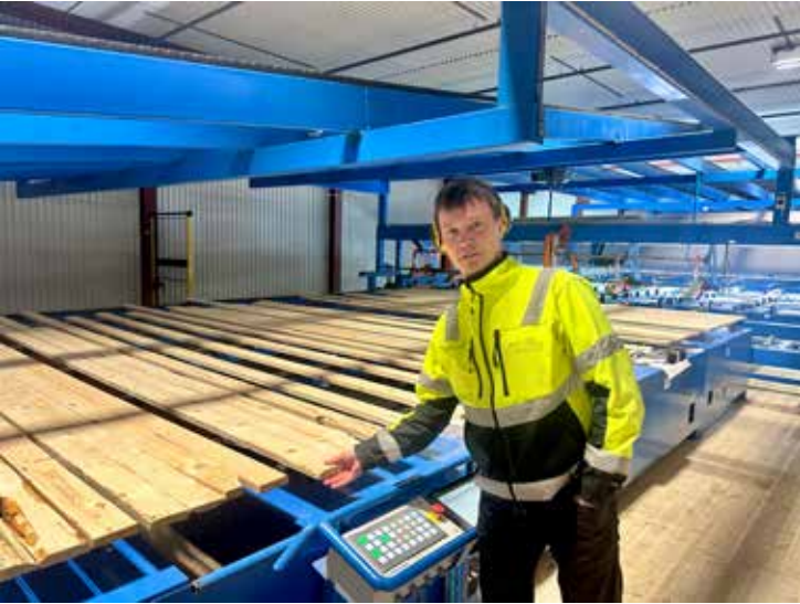
Dan Olofsson, produktionstekniker, lär upp AI-funktionen i Microtech-scannern. Vilka kvistar kan orsaka problem? Vilka andra skador måste kapas bort?
