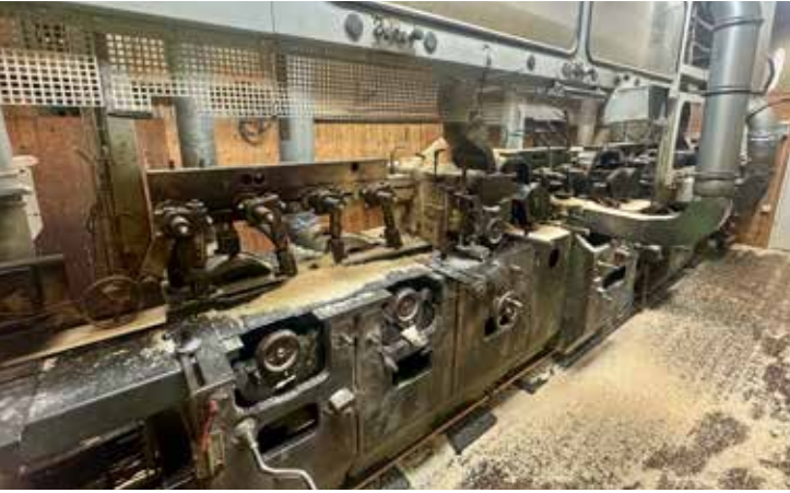
Hyveln kan anpassa virket efter kundens specifikation och ut kommer tusentals meter panel med spont.
