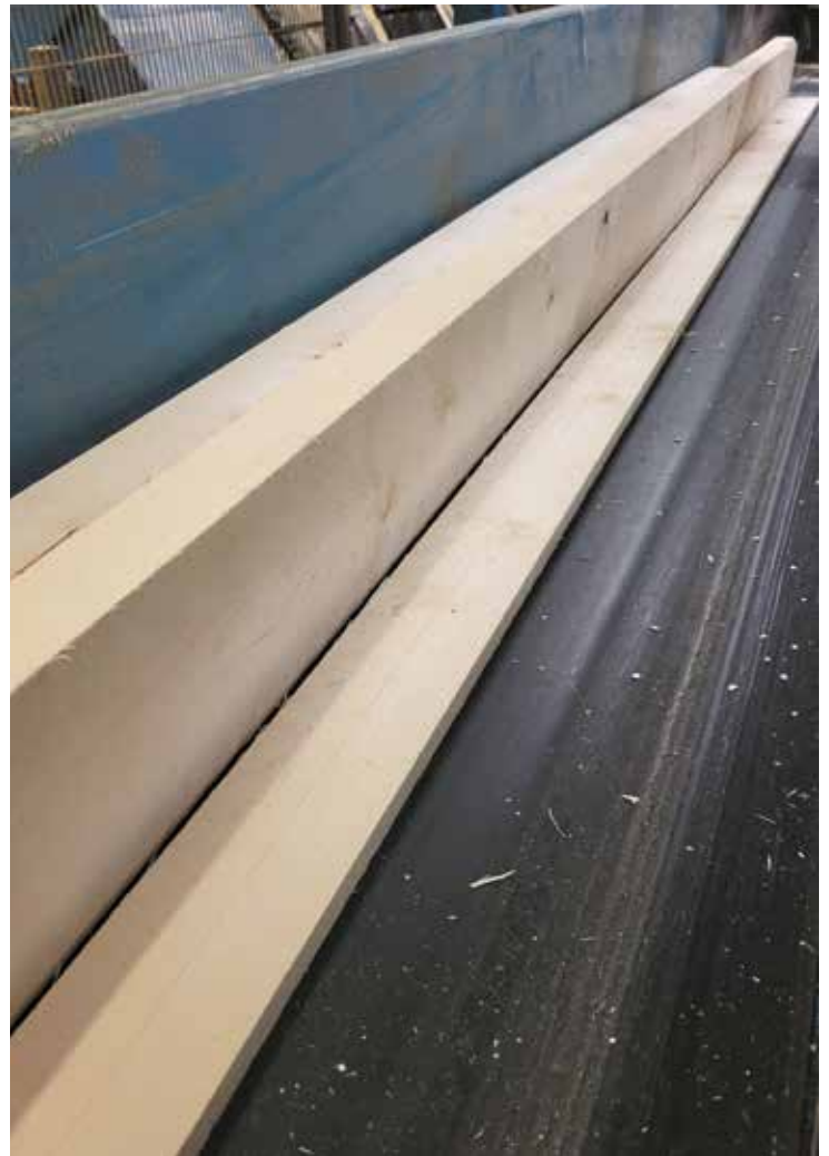
Fin björk sågas. Björk är ett hårdare träslag som till och med efterfrågas som mellanlägg till tyngre gods inom stålindustrin.
