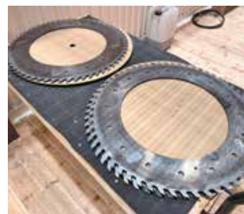
Nya sågverket har fler sågklingor, två som försågar, ytterligare två som sågar igenom helt.
